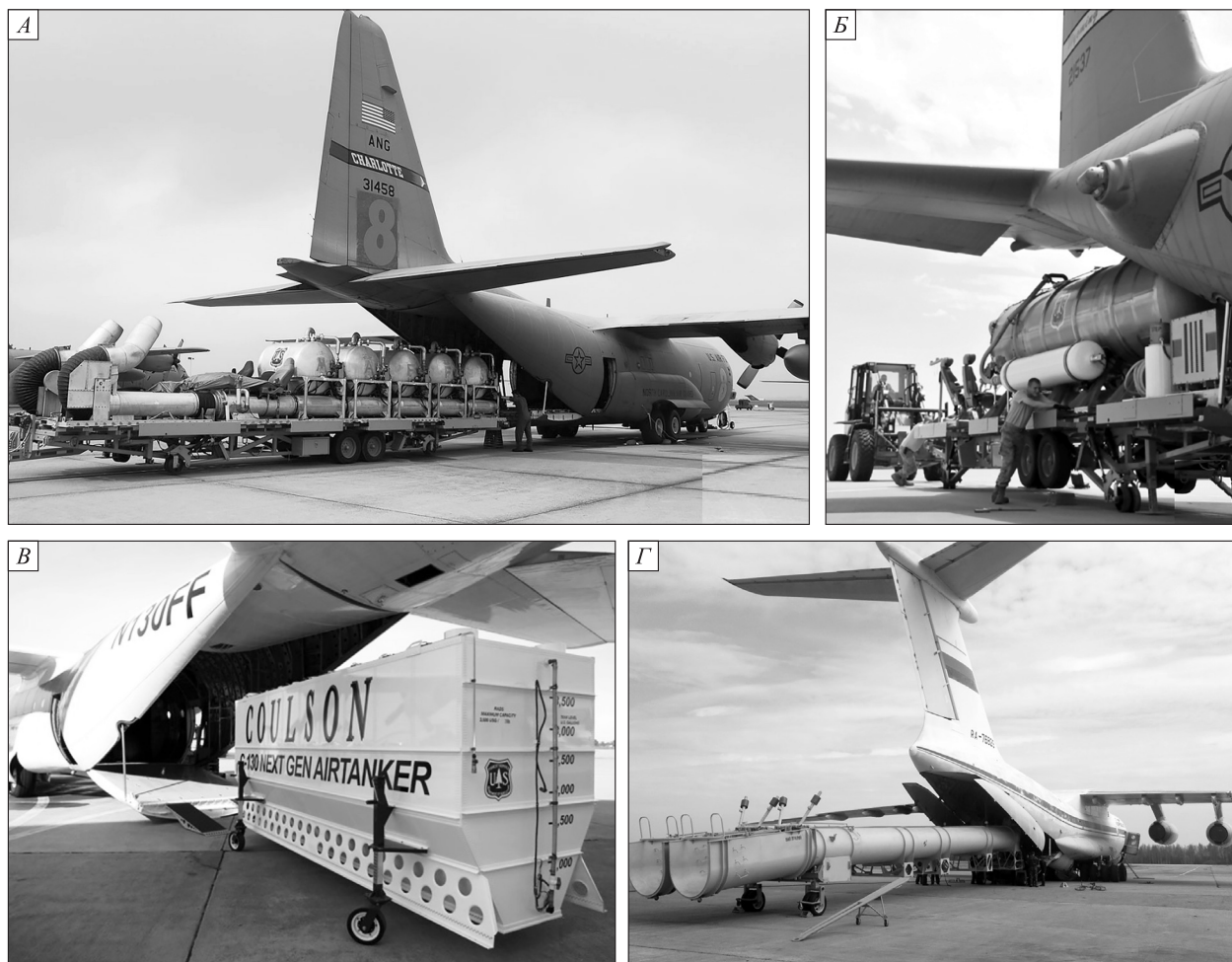
Рис. 2. Установка современных систем модульного тушения в транспортные самолеты. Системы: А – MAFFS; Б – MAFFS II (MAFFS..., 2017); В – Coulson RADS (Coulson..., 2017); Г – ВАП-2 (Госзаказ..., 2012).
