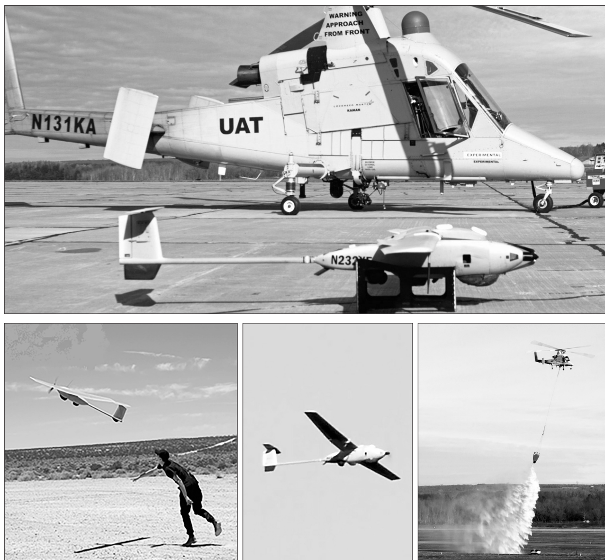
Рис. 4. Испытания комплекса для обнаружения и тушения пожаров, состоящего из беспилотного вертолета UAT K-MAX и легкого патрульного беспилотного аппарата Stalker XE (Lockheed Martin..., 2015).
